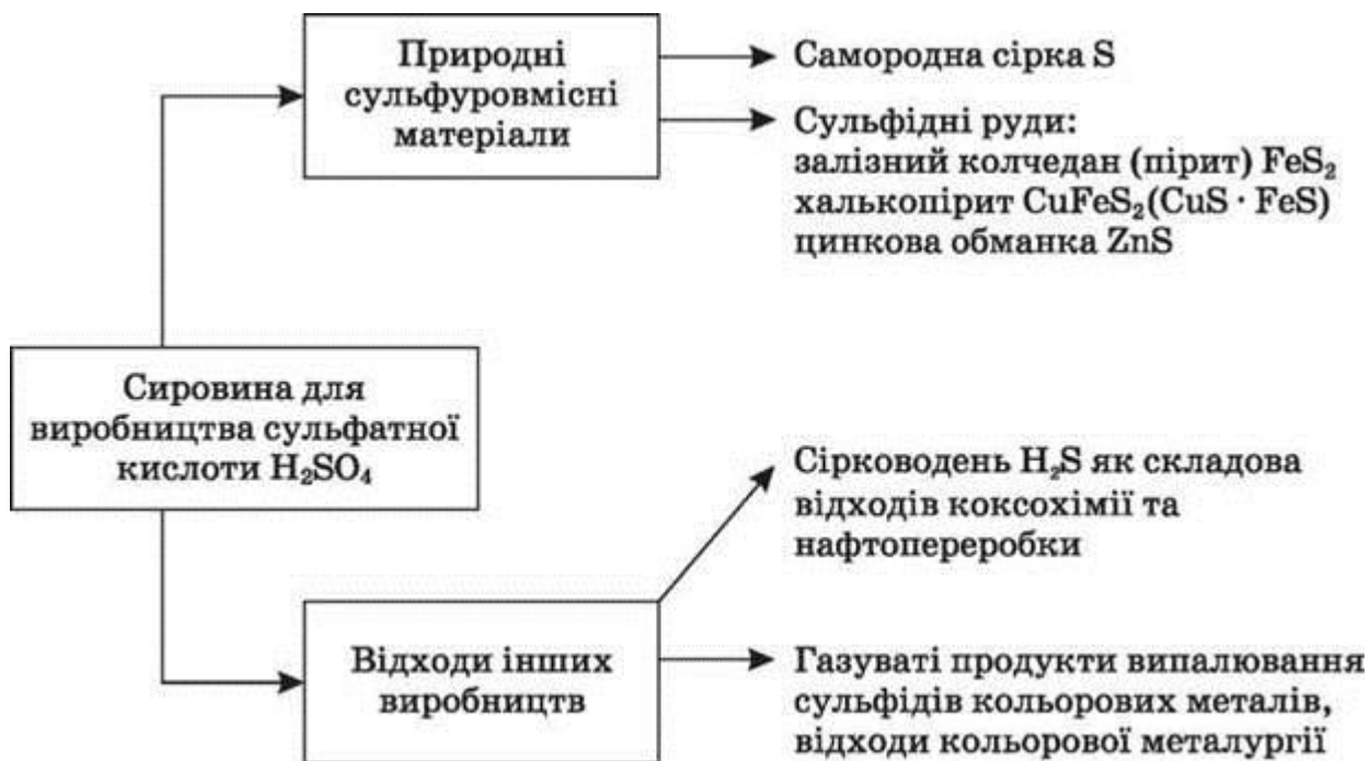
Рис.2. Схема сировини для виробництва сульфатної кислоти
