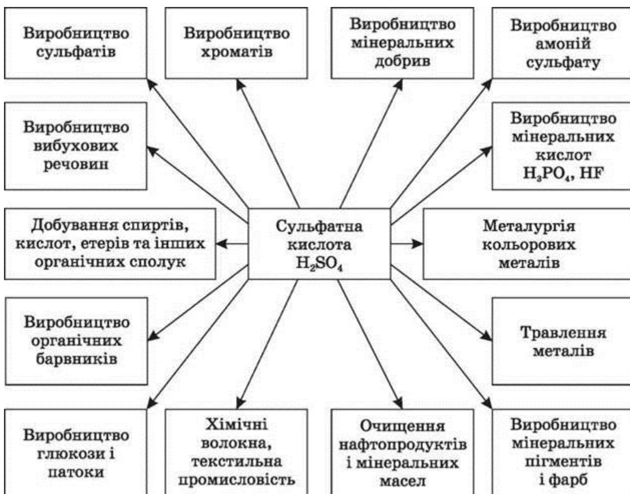
Рис.1. Схема застосування сульфатної кислоти
