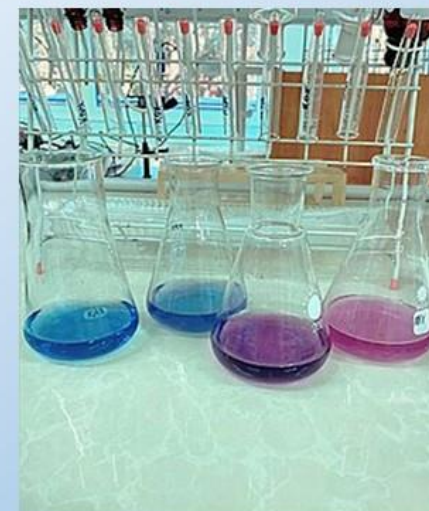
Визначення вмісту іонів +Ca та +Mg у воді методом комплексометричного титрування
