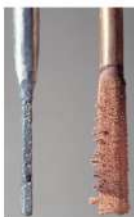
Рис. 4. Електроди відпрацьованого гальванічного елемента.
