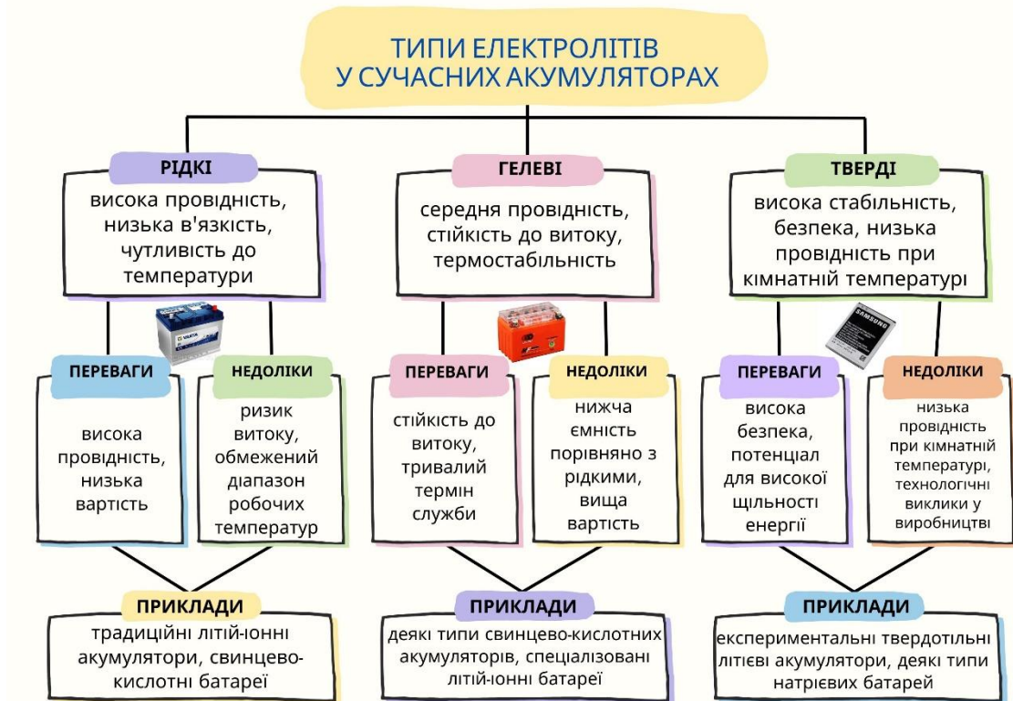
Схема 1. Типи електролітів у сучасних акумуляторах
