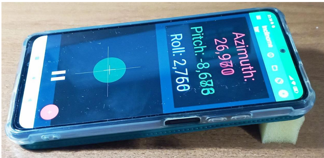
Рис. 27. Вимірювання нахилу смартфону за допомогою програми «PhysicsToolboxSuite» (як пружну опору використано губку)
