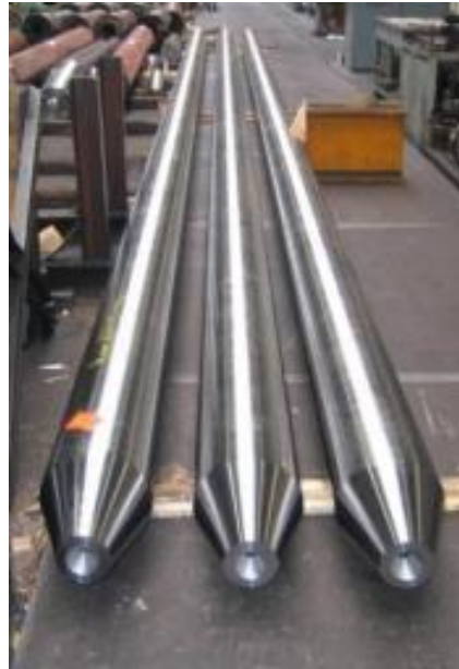
Рисунок 6 – Загальний вигляд оправки безперевного стану
