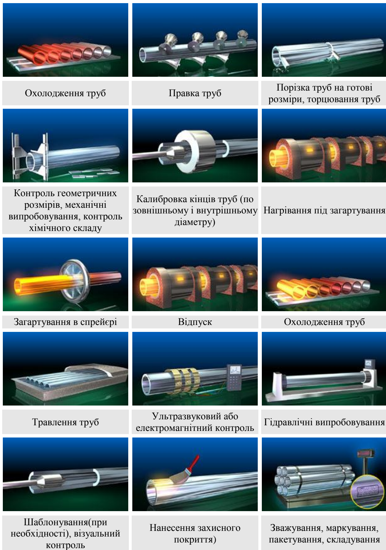
Рисунок 17 – Схема технологічного процесу виробництва труб на ТПА 30 – 102
