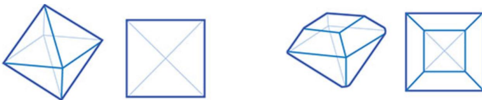
Рис. 12 – Найпростіше огранювання алмазів
