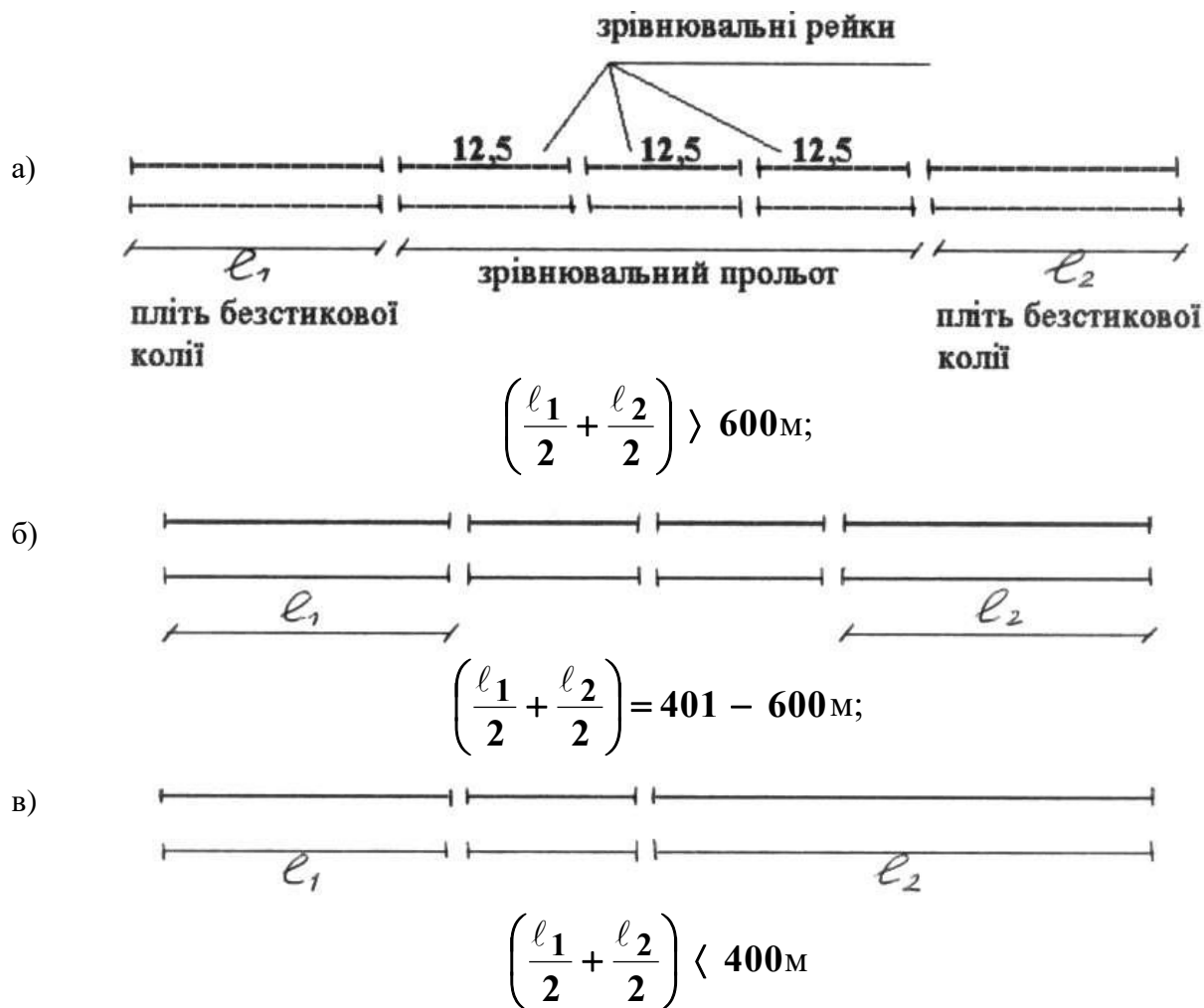
Рис. 2.43. Схеми зрівнювальних прольотів при різній довжині з'єднаних рейкових плітей:
