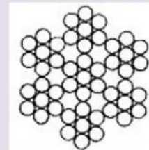
Канат сталевий подвійного звивання типу ЛК-3 6 \times 25 (1+6;6+12) + 7 \times 7 (1+6)
