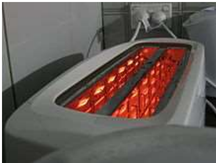
Нагрівальні елементи сучасного тостера на 2 скибочки хліба
