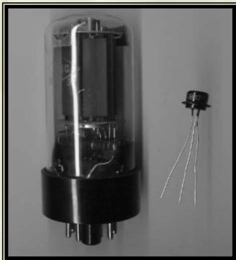
Вакуумна лампа (зліва) та транзистор
