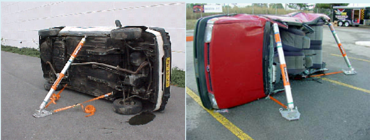
Рис. 6.18. Способи фіксації автомобіля який лежить на боку.
