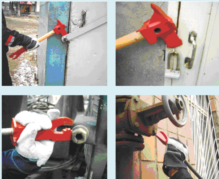
Рис. 3.22 та 3.23 Розділення на частини інструментом ІРАР
