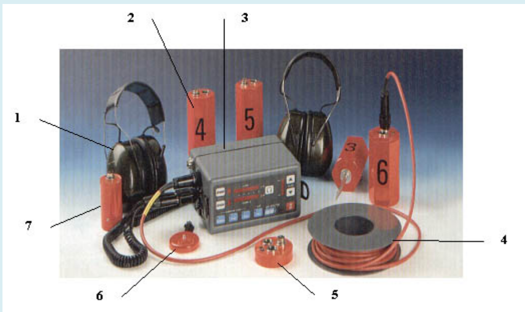
Рис. 5.16. Загальний вигляд геофона:
