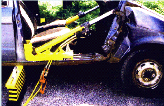
Рис. 7.19. Відтискання передньої частини автомобіля
