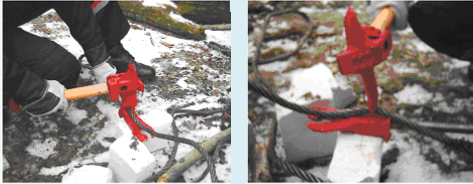
Рис. 3.24. Перебивання троса інструментом ІРАР
