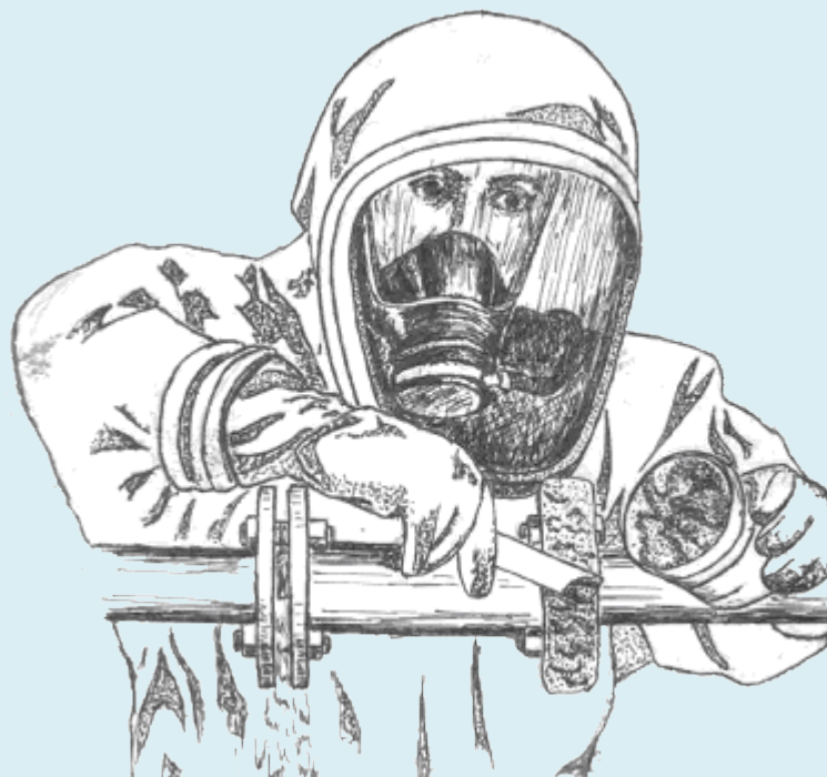
Рис. 4.7. Герметизація фланцевих з'єднань
