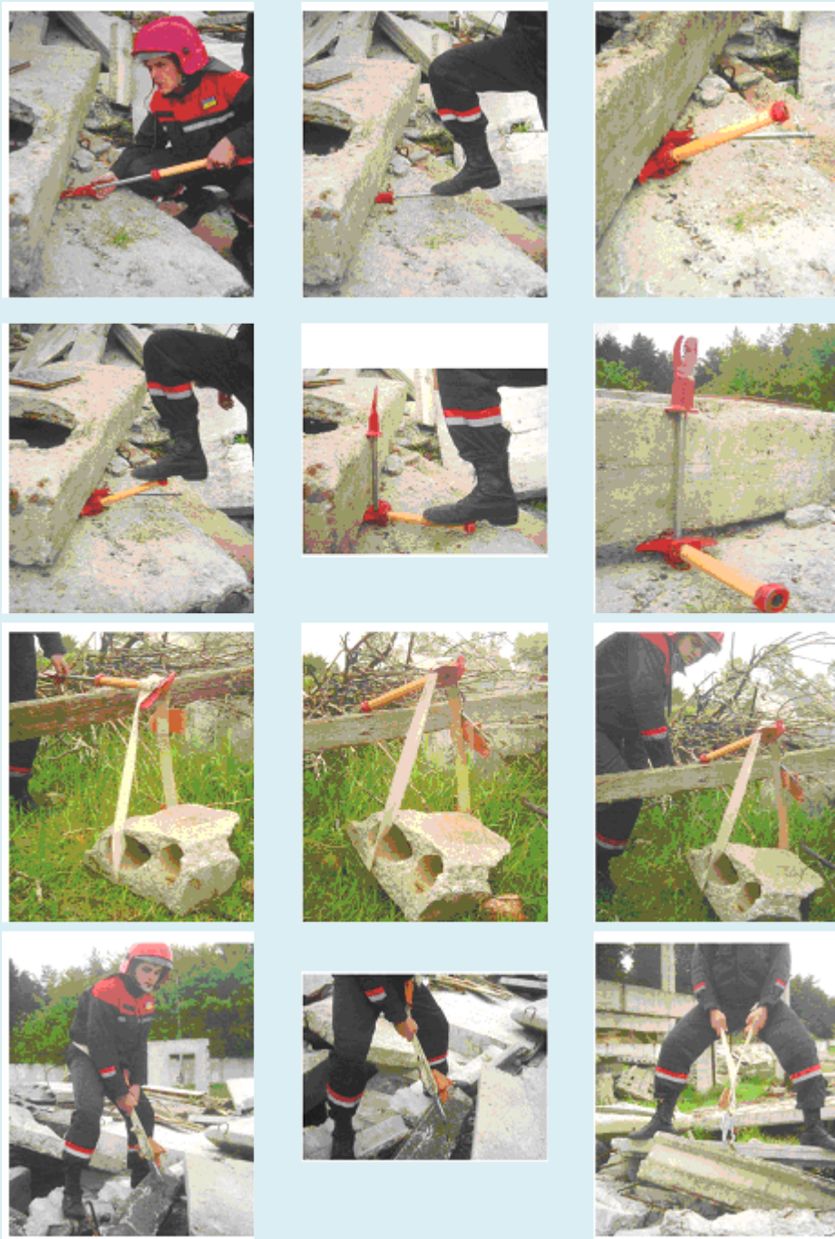
Рис. 3.27. Підняття за допомогою інструмента ІРАР
