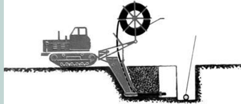
Схема прокладання пластмасової труби безтраншейним способом
