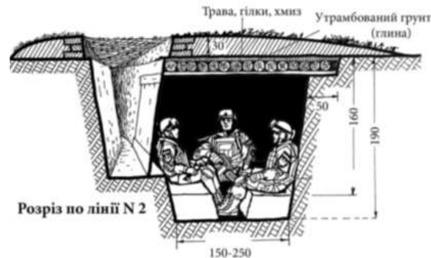
Мал. 17.2. Підбрустверний бліндаж Разрахований не більше ніж на трьох бійців
